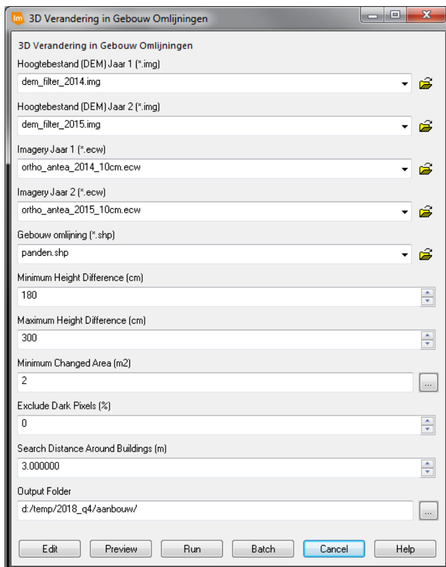
Invoerscherm met ingevulde parameters binnen 3D Verandering in Gebouw Omlijnen.
