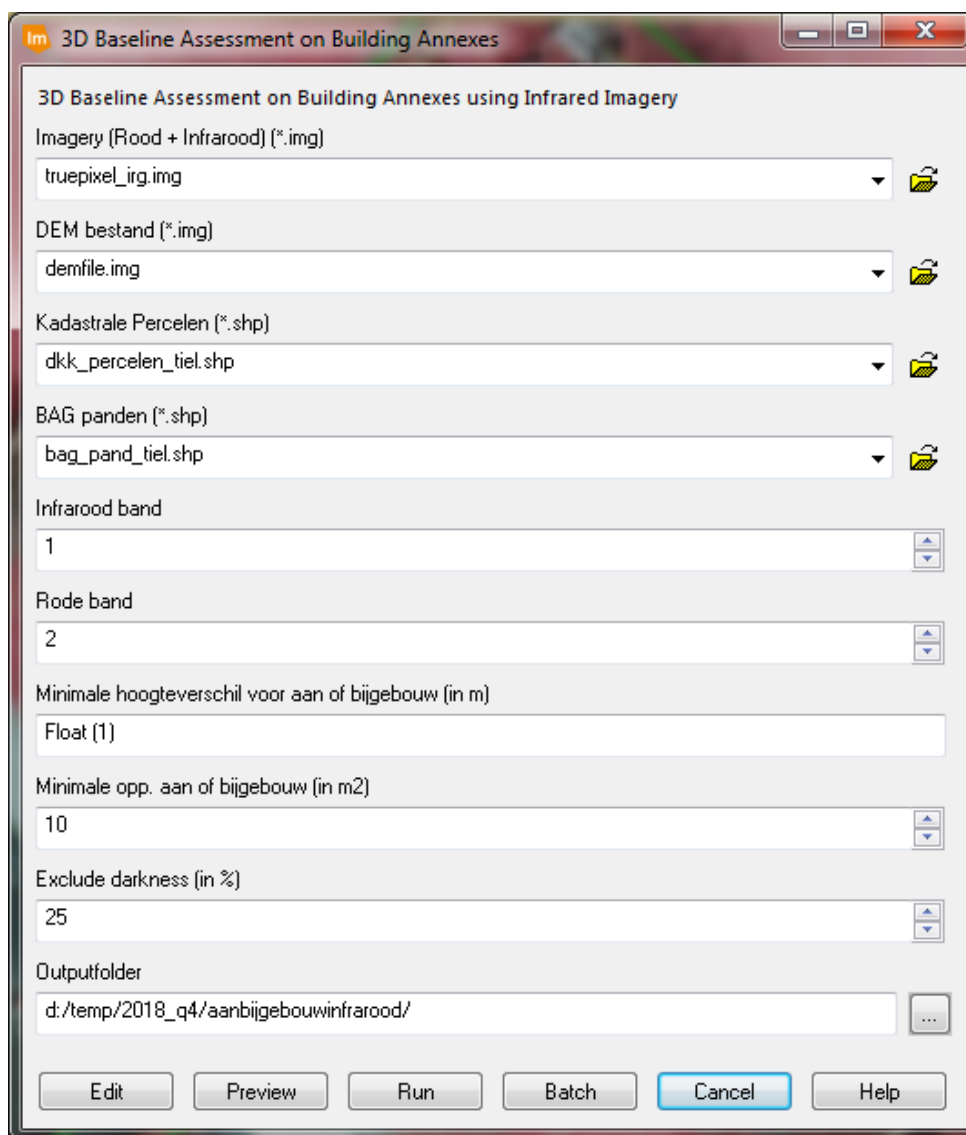
Het invoerscherm met alle ingevulde parameters van 3D Nulmeting op de BGT voor aan- of bijgebouwen.
